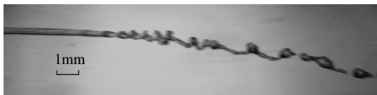
图 4 工况 u_a=25.6\text{ m/s} , v_j=7.8\text{ m/s} 时的射流变形破碎结果 Fig. 4 Breakup process of the liquid jet at u_a=25.6\text{ m/s} , v_j=7.8\text{ m/s}
